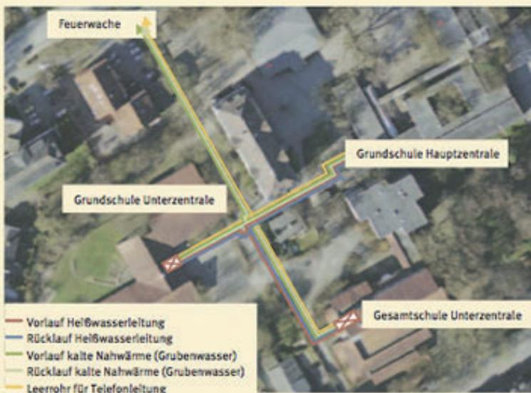
Abb. 4 So wurden die „kalte Nahwärmetrasse“ (grün) und die Fernwärmeleitung (rot) auf dem Schulgelände verlegt.
